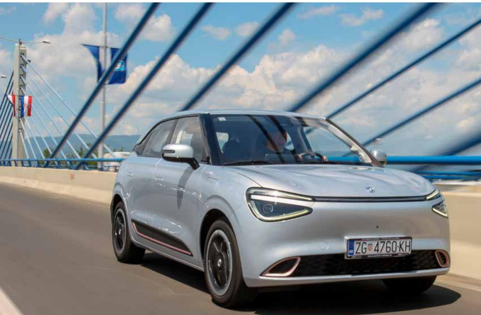
Ovisno o odabranoj bateriji, Dongfeng navodi električni WLTP-doseg vožnje od 230 za manju, odnosno 310 kilometara za veću opciju. Pored toga, Box s razinom opreme Premium ima i V2L mogućnost vanjskog punjenja drugih uređaja, poput električnih bicikala, aparata za kavu ili slično. Obje baterije mogu se puniti DC-strujom do 80 kW, što za napunjenošć od 30 do 80 posto traje oko 45 minuta.
